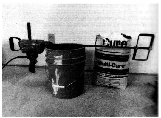
Figure 22-4. Thin-set ceramic tile mortar.
